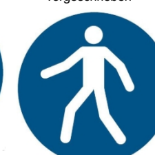
M024 – Durchgang benutzen
