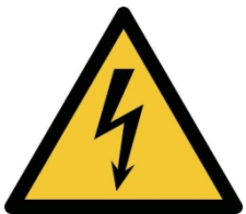
W012 – Gefahr durch Elektrizität
