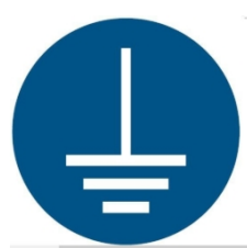
M005 – Erdung erforderlich
