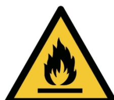
W021 – Gefahr durch brennbare Stoffe
