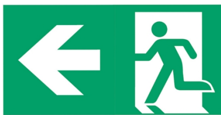
E001 – Notausgang links + Pfeil nach links
